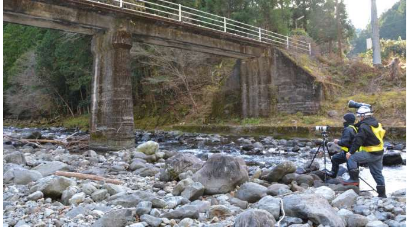
橋脚 大型ストロボ使用 精度 0.2mm
